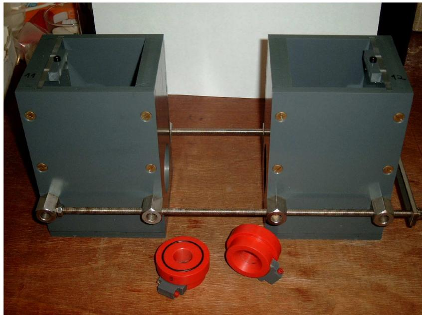
Abbildung 2.8: Verwendete Festgesteins-Messzelle für die SIP-Messungen.
