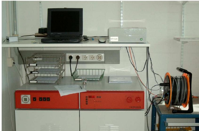
Abbildung 2.7: Verwendete Messapparatur „SIP-Fuchs“ von Radic-Research zur Messung der Spektralen induzierten Polarisation. Der abgebildete Klima-Schrank sorgt während der Messung für eine konstante Temperatur von 20 °C und stellt zusätzlich einen Faraday-Käfig dar.
